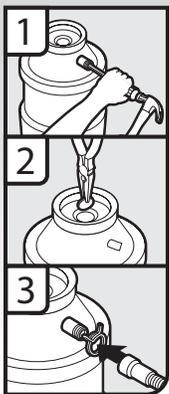
1. Arracher l'opercule arrachable du broyeur à déchets – utiliser un marteau et un tournevis.
